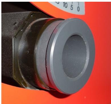
(Réduction du diamètre de 58 à 36 mm)
