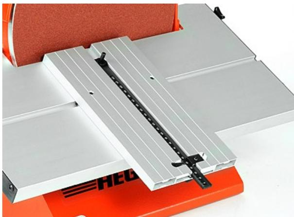
Le dispositif de ponçage circulaire permet de poncer la périphérie de flans circulaires munis d'un perçage au centre de 6,8, 10, 12, et 15 mm de diamètre au choix. Le périmètre extérieur à poncer est réglable de 30 à 400 mm.
