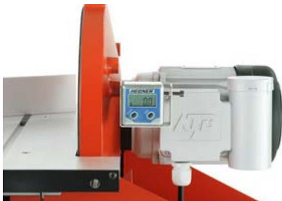
Un dispositif pour mesurer (électroniquement) les angles avec une précision de mesure de +/- 0.1 degré.
