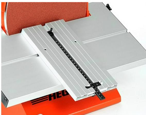
Le dispositif de ponçage circulaire permet de poncer la périphérie de flans circulaires munis d'un perçage au centre de 6,8, 10, 12, et 15 mm de diamètre au choix. Le périmètre extérieur à poncer est réglable de 30 à 400 mm.
