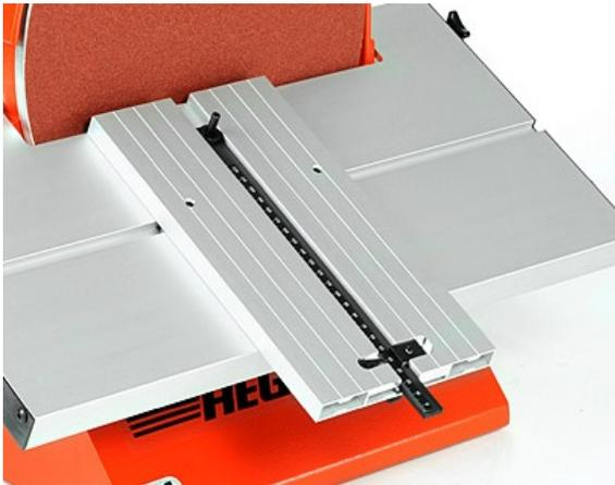
Die Rundschleifeinrichtung gestattet das Rundschleifen von rohen Scheiben, welche eine Bohrung in der Mitte haben. Für Bohrungen mit einem Durchmesser von wahlweise 6, 8, 10, 12 und 15 mm. Der zu schleifende Außendurchmesser ist einstellbar von 30-400 mm.
