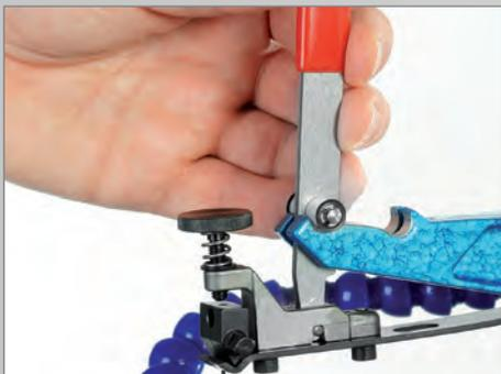
Dispositif de tension rapide de la lame
